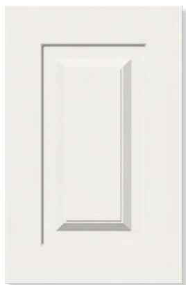
ALICE HVIT ELLER FARGET Malt dør av 19 mm MDF-plate med frest profil og svakt avrundet kant. Fås også i vitrine med klarglass til høyskap.
